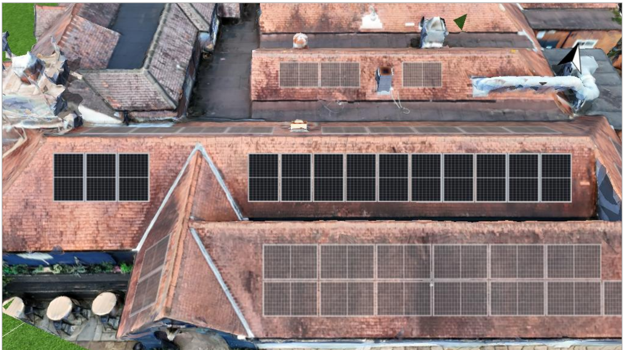
Figure: 3. Module Area - Elevation F
