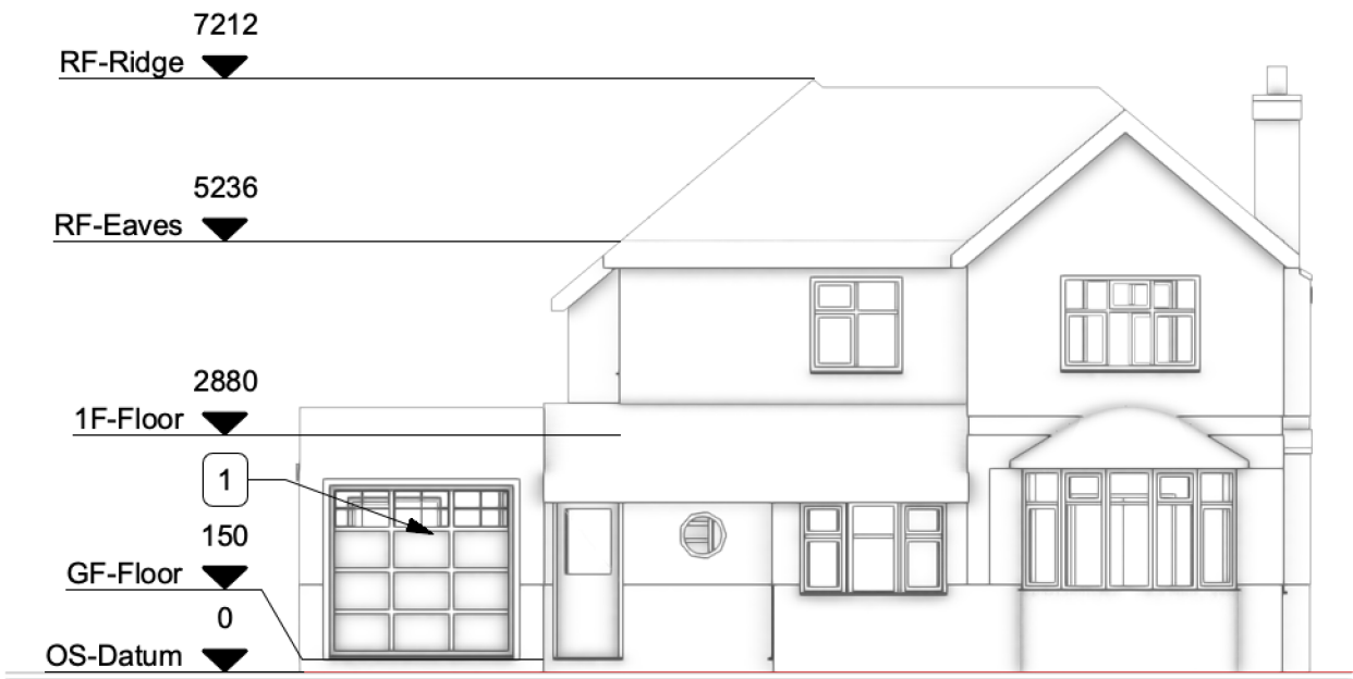
1 West Elevation - Existing Scale: 1:100
